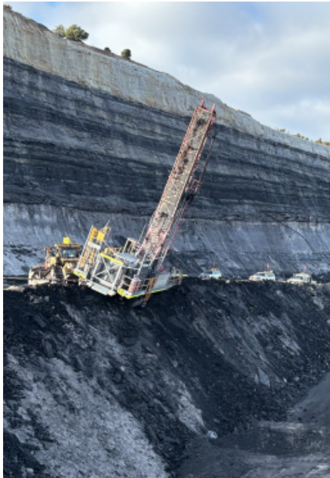
Drill rig over edge
